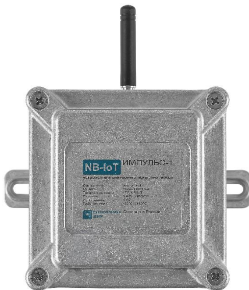
Рисунок 5 – Расположение крышки прибора относительно антенны в закрученном состоянии
